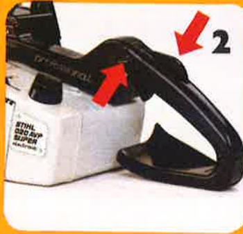
**3+4** Slik fungerer Quickstop kjedebrems: Dersom bremsearmen utløses ved hjelp av den fremre håndbeskytteren skjer i samme brøkdel av sekund at det forspente bremsebåndet (rødt) omslutter kjededrevet (blatt) og bringer dette til stillstand. Kjedet er fastlåst – mens motoren går.
